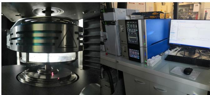
Figure 4 : Plateforme constituée d'un rhéomètre couplé à des spectromètres Raman et infrarouge, et d'une chromatographie d'exclusion stérique reliée à un détecteur à diffusion de lumière multi-angles
