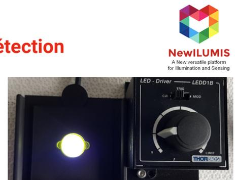
Figure 8 : NewLUMIS : Sonde de détection utilisant des LED de très forte intensité et des substrats YAG dopés
