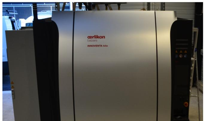
Figure 2 : Machine de dépôt PVD INNOVENTA KILA
