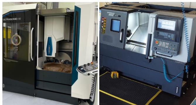
Figure 10 : De gauche à droite : Centre d'Usinage 5 axes DMG MORI DMU 50 US, Tour CN 3 axes DOOSAN Lynx 2100 LMB
