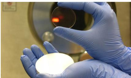
Figure 12 : Céramique polycristalline de YAG (grenat d'yttrium et d'aluminium) pour application laser avant et après frittage.
